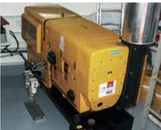
Der im Bugstrahlraum montierte HATZ Silent Generator sorgt bei Ruhezeiten für lärmarme Energieversorgung
