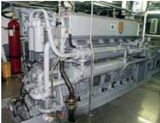
Der 1800 PS leistende Antriebsmotor von ABC mit angeflanschtem Reintjes-Getriebe von promarin Bilder: Dünner
