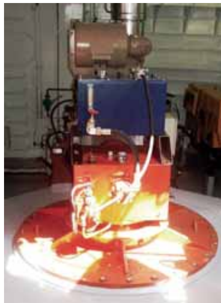
Motorschiff und Schubleichter verfügen über identische Van der Velden Bugstrahlruderanlagen...
