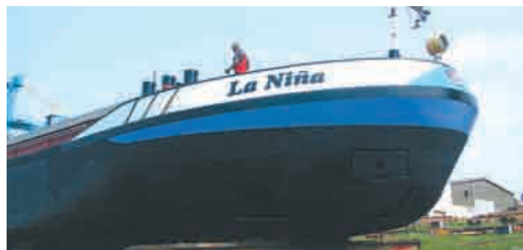
● De "bolle" traditionele kop is bewezen gunstig voor de snelheid van de koppelverbanden die al met dit type duwbak varen
